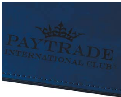
■ wypalanie laserem na materiale Vivella
